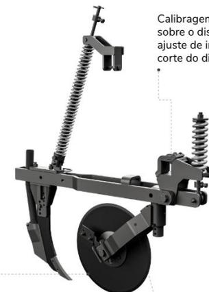
Calibragem da pressão sobre o disco de corte e ajuste de inclinação de corte do disco
